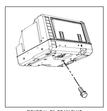
FIGURE 11. OIL DRAIN PLUG
