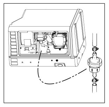
FIGURE 15. FUEL FILTER (GASOLINE MODELS ONLY)
