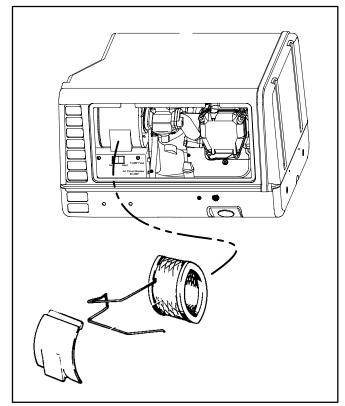
**FIGURE 12. AIR FILTER ELEMENT**
