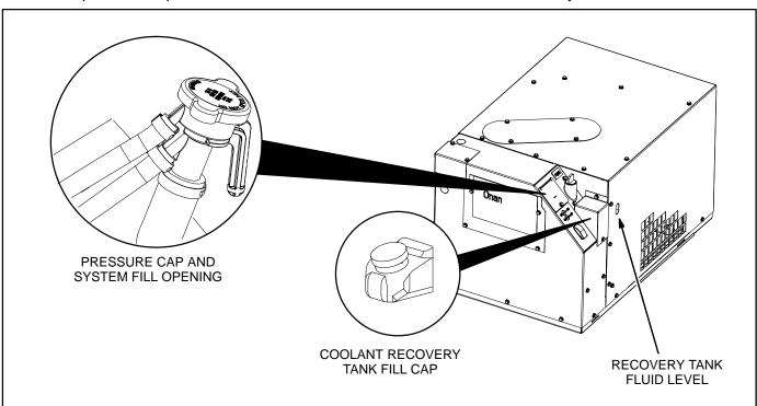
FIGURE 15. ENGINE COOLING SYSTEM PRESSURE CAP AND RECOVERY TANK
