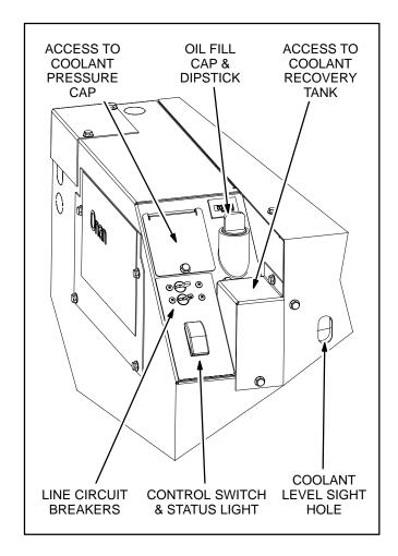
FIGURE 4. OPERATOR'S CONSOLE
